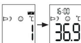
4. Ölçüme devam etmek istiyorsanız START düğmesine basın. Kulak termometresini kapatmak istediğinizde Açıma/Kapama düğmesini
