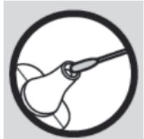
Die Sensorspitze ist das empfindlichste Teil des Ohrthermometers. Arbeiten Sie bei der Reinigung der Sensorspitze vorsichtig, um eine Beschädigung zu vermeiden. Verwenden Sie dazu ein weiches Tuch oder ein Wattestäbchen, welches mit Desinfektionsmittel, Alkohol oder warmem Wasser angefeuchtet werden kann.
