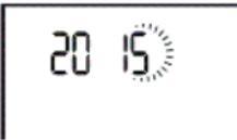
6. Auf dem Display blinkt die Monatsanzeige. Wählen Sie mit der START-Taste den aktuellen Monat und bestätigen Sie mit der EIN/AUS-Taste ⌂. Das Gerät schaltet sich anschließend automatisch aus. Datum und Uhrzeit sind nun gespeichert.
