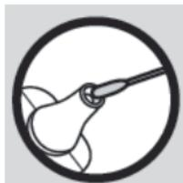
Końcówka czujnika to najbardziej czuły element termometru dousznego. Aby uniknąć uszkodzenia, należy zachować ostrożność podczas czyszczenia końcówki czujnika. W tym celu użyć miękkiej szmatki lub patyczków z wata, które można nasączyć środkiem dezynfekującym, alkoholem lub ciepłą wodą.
