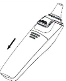
3. Inserire due nuove batterie AAA da 1,5V. Accertarsi che le batterie siano orientate correttamente. Chiudere il vano batterie.
