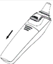
3. Setzen Sie zwei neue 1,5V AAA-Batterien ein. Achten Sie darauf, dass die Batterien richtig ausgerichtet sind. Verschließen Sie das Batteriefach.
