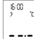
2. Um das Ohrthermometer einzuschalten, drücken Sie die EIN/AUS-Taste ⏹. Es ertönen drei Signaltöne und das Display schaltet sich ein.
