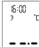
2. Para encender el term metro para el o do, pulse la tecla de encendido y apagado
