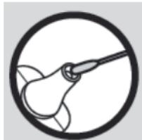
La pointe du capteur est la partie la plus sensible du thermomètre auriculaire. Soyez prudent lors du nettoyage afin d'éviter de l'endommager. Pour cela, utilisez un chiffon doux ou un bâtonnet ouaté qui peut être humidifié avec du désinfectant, de l'alcool ou de l'eau chaude.
