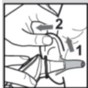
4. Koruyucu kapak takılı sensör ucunu dikkatlice kulak kanalı içine yerleştirin ve ölçme işlemini başlatmak için START düğmesine basın.
