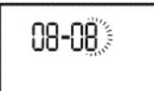
7. Auf dem Display blinkt die Tagesanzeige. Wählen Sie mit der START-Taste den aktuellen Tag und bestätigen Sie mit der EIN/AUS-Taste ⌂.
