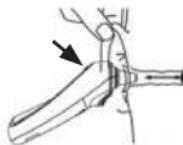
5. Yaklaşık bir saniye sonra bir sinyal sesi duyulur ve ölçüm sonucu ekranda belirir. Kulak termometresini kapatmak için Açıma/Kapama ⌂ düğmesine basın.
