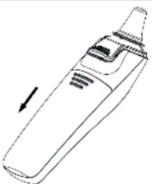
3. Insérez les deux nouvelles piles 1,5 V AAA. Faites attention à ce qu'elles soient positionnées dans le bon sens. Fermez le compartiment à piles.
